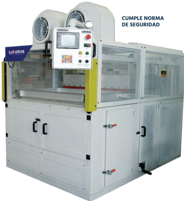
A **SUPRVAC** es una máquina mono estación automática para Vacuum Forming. Tiene horno superior, característica que la hace flexible y con excelente relación costo/ beneficio, especialmente termoformando con una variedad de moldes en un solo turno de producción.
