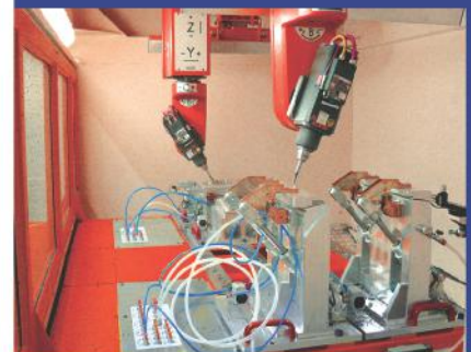
Dois cabeçotes para usinagem simultânea e independente.
